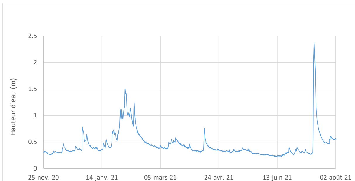
Figure 5 - Evolution des hauteurs d'eau à la station de Bellebouche aval (données horaires avec capteur atmosphérique immergé) du 25 novembre 2020 au 5 août 2021
