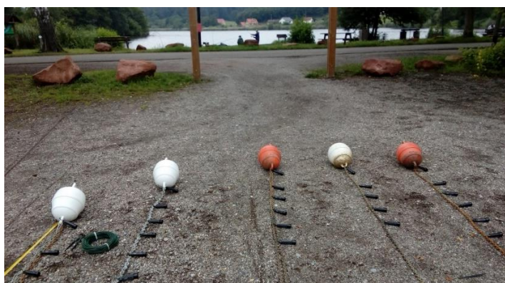
Figure 8: Exemple d'équipement de chaînes de thermomètres enregistreurs en continu en étangs. Q. Choffel, 2018
