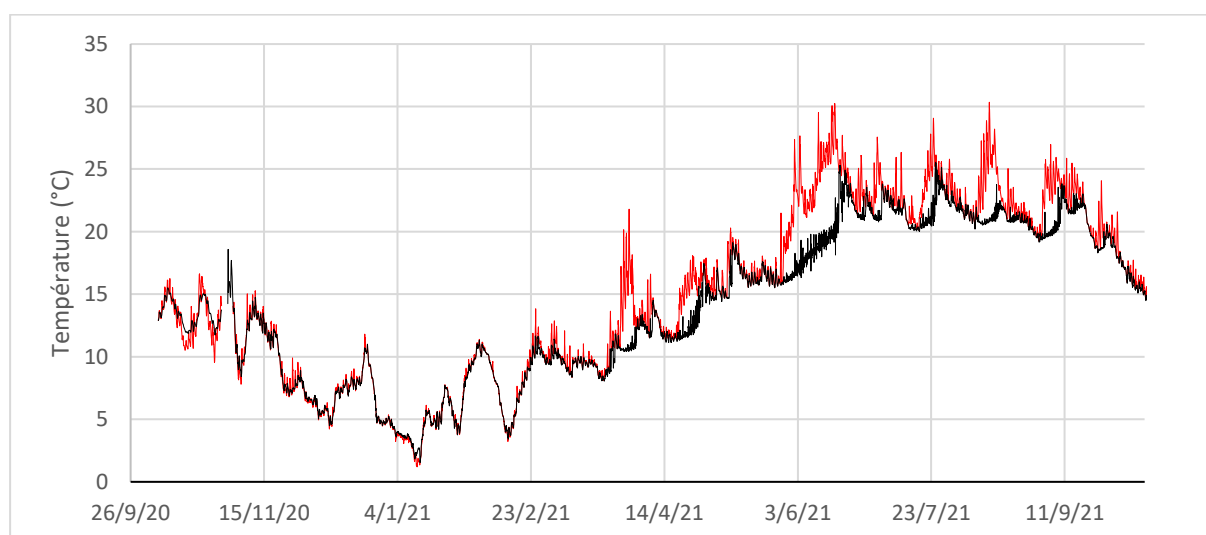
Figure 20: Evolution thermique de la surface (rouge) et à 3m de profondeur (noir) de l'étang de Bellebouche
